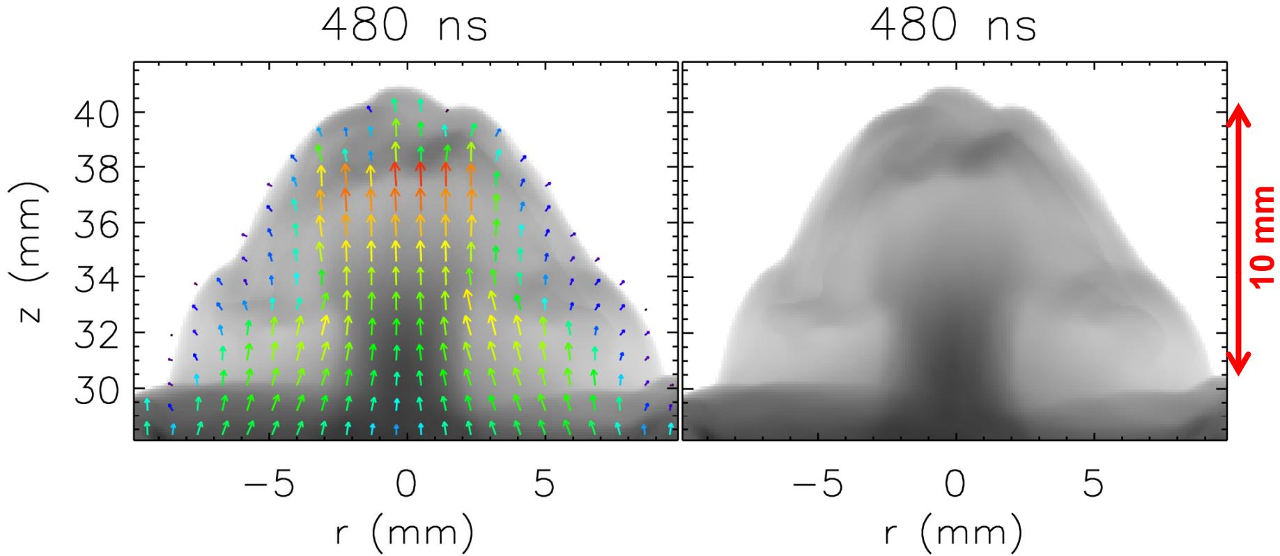
$n_e \sim 1-5 \times 10^{18} \text{ cm}^{-3}$ ,  $T \sim 20 \text{ eV}$ ,  $\rho_{\text{amb}} \sim 5 \times 10^{-6} \text{ g/cc}$ ,  $\rho_{\text{jet}} \sim 1-5 \times 10^{-5} \text{ g/cc}$
